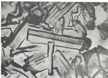
Рис. 1. Электронная микрофотография камня алунитового расширяющегося полимерцемента после 28 суток воздушного твердения
