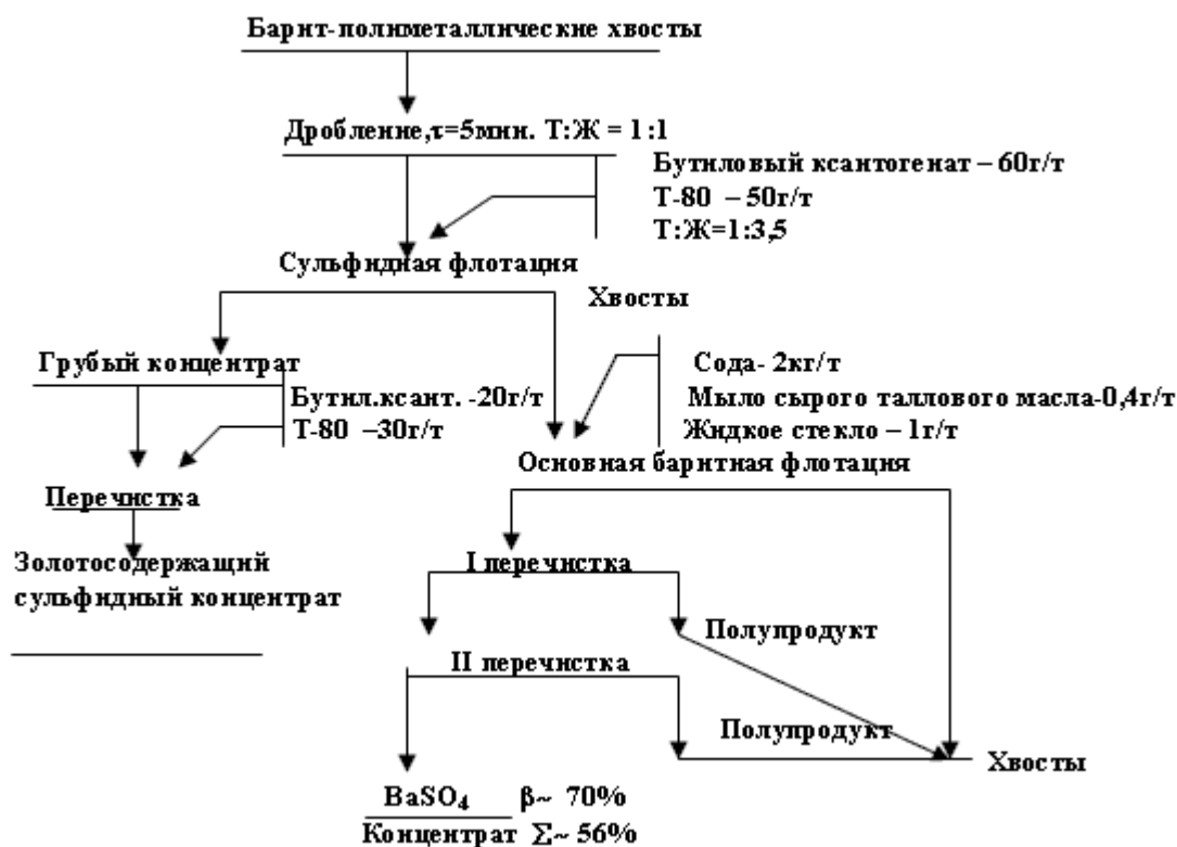
Рис.1. Схема вторичной флотации хвостов барит-полиметаллической руды
