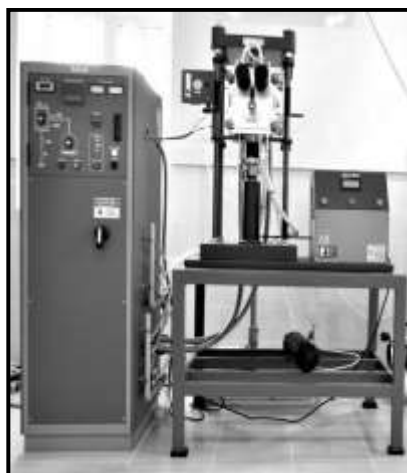
სურ. 2 მაღალტემპერატურული ვაკუუმური ლუმელი (OXY-GON, Model № FR210-30T-A-200-EVC)
