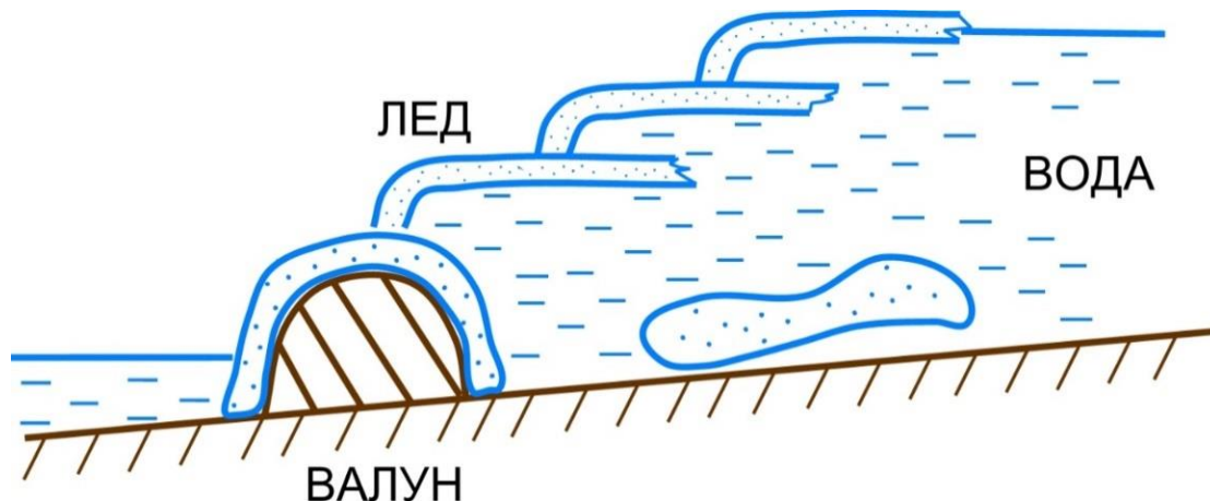
Рис. 3. Структура водо-ледяной ступени на горной реке (продольный разрез).
