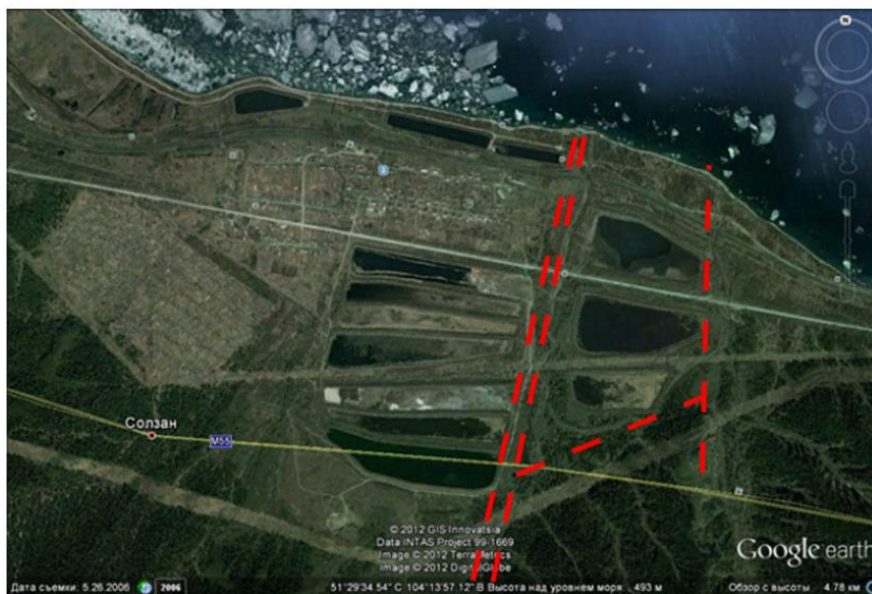
Рис. 8. Пунктирными линиями показано возможное размещение потоконаправляющих дамб для защиты от наполнения карт-накопителей БЦБК от паводков и селей
