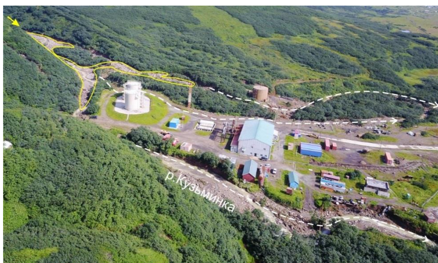
Рис. 8. Разделение селевого потока на рукава выше электростанции (сплошная линия). Пунктиром показано направление движение селевого паводка. Фото А.В. Кундиуса.
