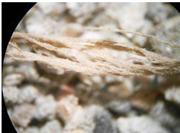
10. რომანევენტის ნაღესობის შემავსებელი ნაბჯის და ნახშირის მარცვლების ჩანართებით Fillers of the Roman cement with granules of fibers and grains of charcoal
