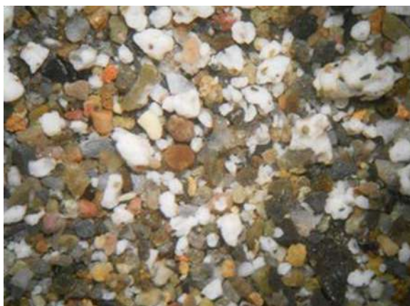
12. ფურცელაძის ქ. #1: გრანულომეტრიის ნაღეში ფიქსირდება დიდი რაოდენობით თაბაშირის მარცვლები 1 Purtseladze street: granulometric sediments demonstrate a high number of gypsum grains
