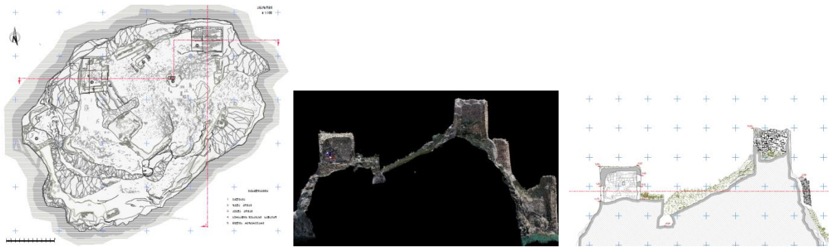
სურ.5. წერტილთა ღრუბელზე დაყრდნობით არქიტექტურულ-არქეოლოგიური ნახაზების შექმნა - გეგმა, ჭრილი 1-1
